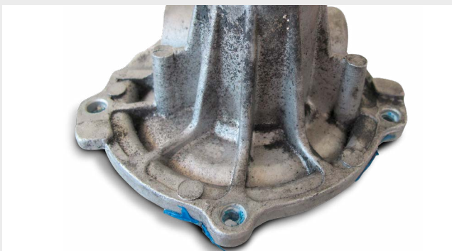
Danos nos rolamentos devido a problemas na correia (abrasão da borracha, partículas no invólucro)
