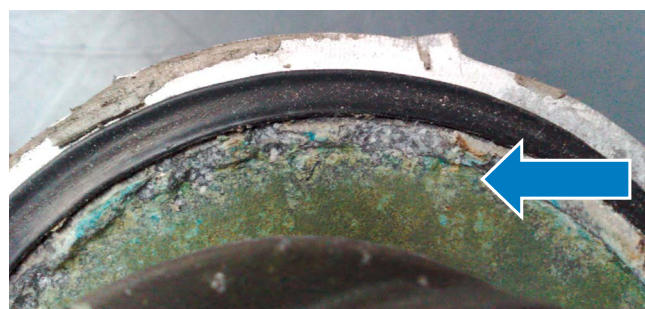
Líquido de refrigeração inadequado causou corrosão e fugas
